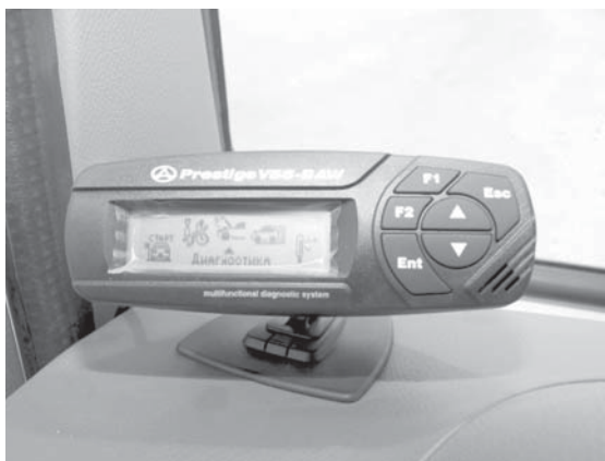
Для отображения диагностической информации в кабине установлен дополнительный бортовой компьютер
