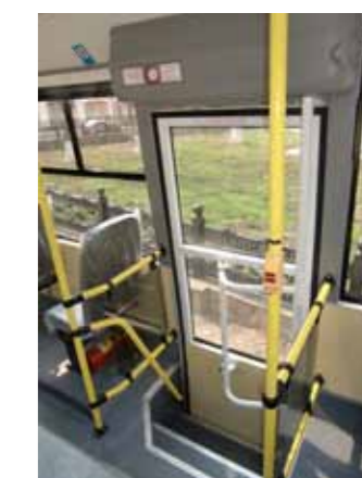
Стекло двери изнутри пересечено усилителем
