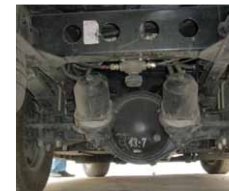
Вместо старых энергоаккумуляторов теперь стоят пружинные с пневмууправлением
