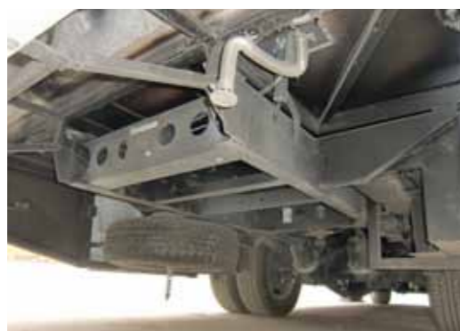
Конструкция автобуса рамная
