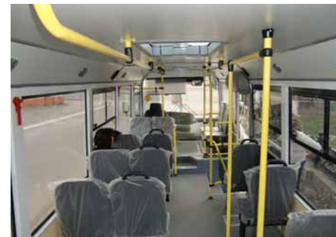
Для вентиляции салона служат большие сдвижные форточки и два потолочных люка
