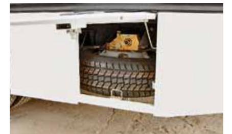
Доступ к запасному колесу – через люк, в заднем свесе автобуса
