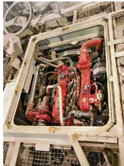
Китайский дизельный двигатель скрыт под люком в переднем свесе
