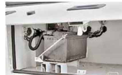
Аккумуляторная батарея в отдельном, влагонепроницаемом отсеке
