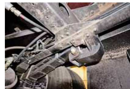
Крепление задних рессор – литые кронштейны, приклепанные к раме
