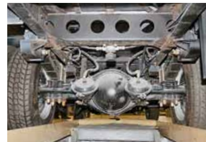
Тормозные камеры ведущего моста без энергоаккумуляторов
