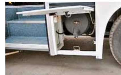
За передним колесом расположен корпус воздушного фильтра
