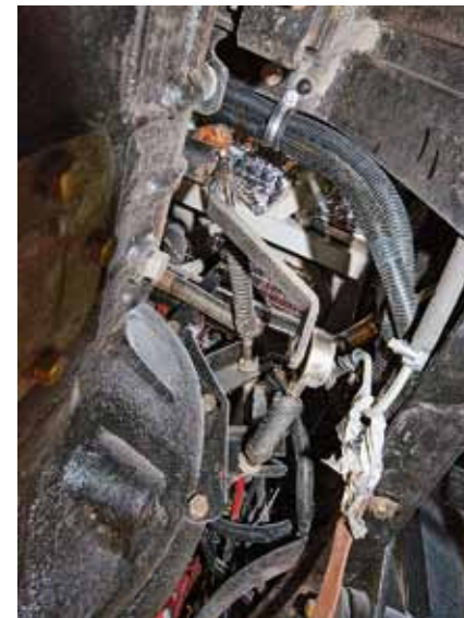
Усилие от рычага КП на механизм переключения передают тросы
