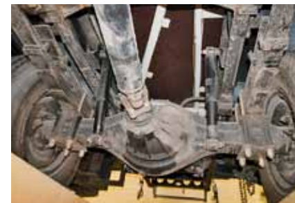
Нагрузки на задний мост невелики, потому он одноступенчатый
