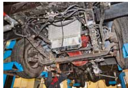
Передняя подвеска автобуса – неразрезная балка моста на рессорах
