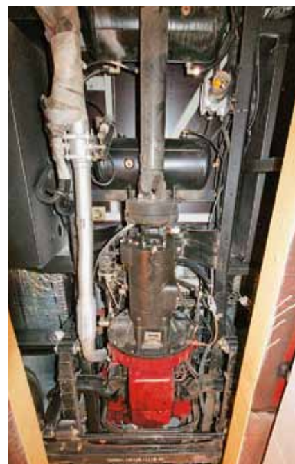
Стояночный тормоз барабанного типа, расположен на фланце КПП
