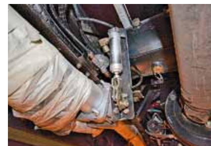
Моторный тормоз автобусов компрессионного типа – заслонка на выпуске
