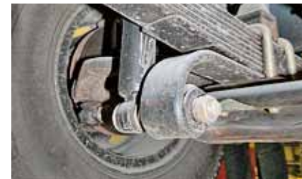
Опоры передних амортизаторов – оригинальные завитые кронштейны
