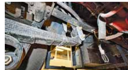
Передние многорычковые рессоры закреплены к раме через серьги
