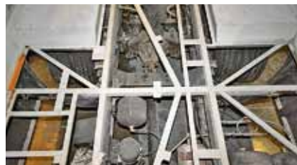
Прежде чем соединить с шасси, каркас покрывают грунтом
