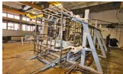
Стпель экономит время, затрачиваемое на сварку каркаса кузова
