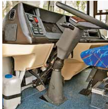
Рулевая колонка с регулировкой под индивидуальную комплектацию водителя
